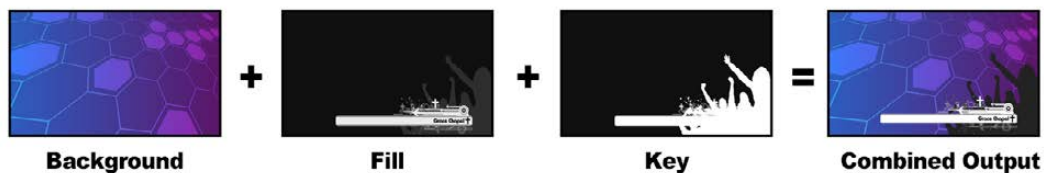
Kombination eines Hintergrunds mit Füll- und Stanzsignalen in Form eines Luma-Keys
