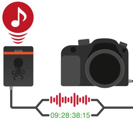
**Bitte beachten:** Das eingebaute Mikrofon kann nur dann genutzt werden, wenn mit einem Mic-Pegel gearbeitet wird und der Mikrofoneingang an der Kamera auf Plugin Power geschaltet ist.
