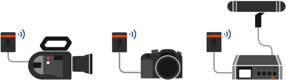
Die Tentacles können mit nahezu jedem Aufzeichnungsgerät genutzt werden: Kameras, Audiorekorder, Monitore und mehr. Alles was ein Gerät benötigt, um mit einem Tentacle verbunden zu werden ist entweder ein Timecode-Eingang oder mindestens eine freie Tonspur.
